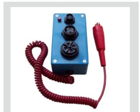
Un testeur de branchement facile à utiliser est disponible chez Smith-Root. Il permet à une personne d'effectuer facilement des tests ci-dessus, avec une alarme sonore et un voyant d'erreur.
