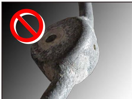
**Une bague d'anode avec une couche d'oxyde importante.**
