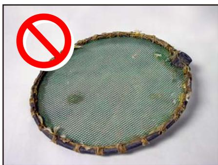
**Une bague d'anode avec un filet attaché n'est jamais une bonne idée.**
