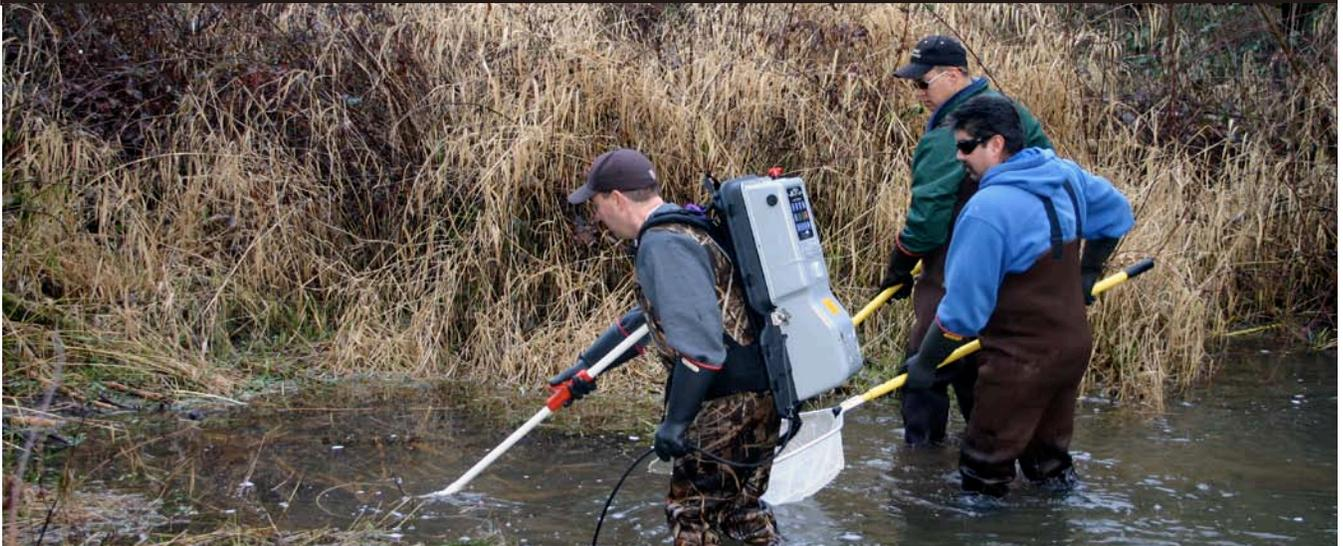
L'équipement d'électropêche utilise des tensions et des courants qui peuvent être mortels pour les humains. Les opérateurs doivent toujours garder à l'esprit que la probabilité de recevoir un choc électrique est multiplié dans ou près de l'eau. Utiliser un électropêcheur, c'est comme utiliser une arme à feu : s'il est utilisé correctement et avec un bon jugement, il est parfaitement sûr, cessez de lui accorder le respect et vous pouvez perdre la vie !
